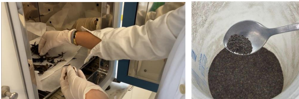
Fig. 6 e 7 – Secagem das amostras em estufa; Alga castanha processada (triturada num moinho de esferas).
