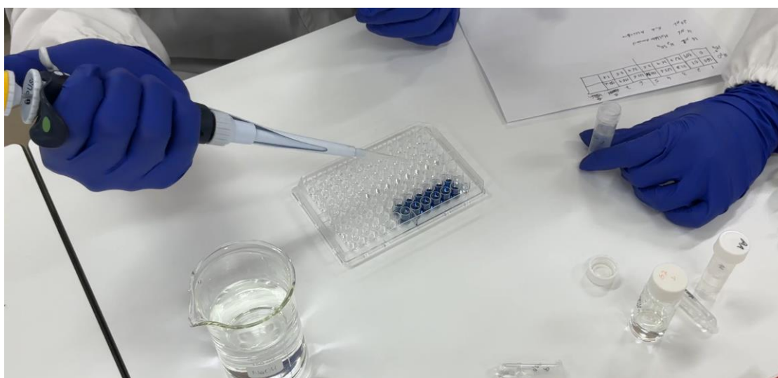
Fig.13 – Preparativos para a obtenção da curva de calibração pelo método colorimétrico.
