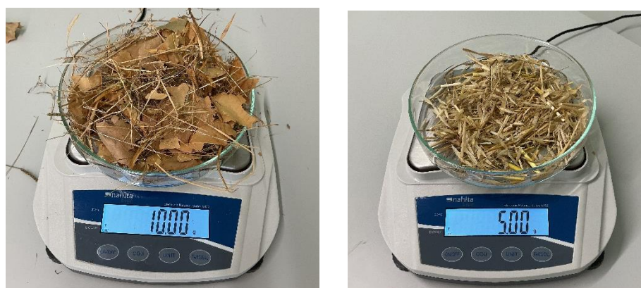
Fig. 31 e 32 – Pesagem do material combustível vegetal para os dois ensaios realizados.
