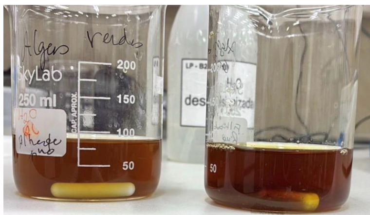
Fig.12 - Precipitação do carbonato de cálcio.
