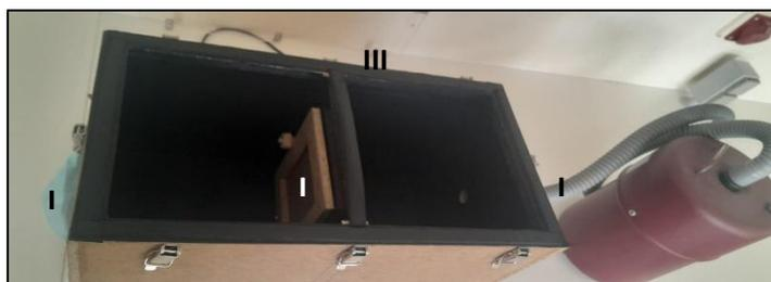
**Figura 3.** Protótipo para a biofiltração do ar. Legenda: I – Entrada de ar contaminado com MPs fluorescentes II – Biofiltro, III- Tampa de acrílico com vedantes IV – Saída do ar através de uma máscara.
