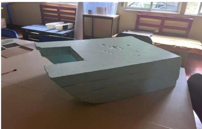
Figuras.8 - Casco do veículo construído em placas de isolamento XPS;
