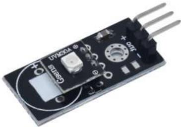
Fig. 31 Sensor de Radiação UV
