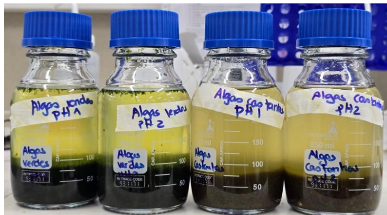
Fig. 9 - Resultado da hidrólise térmica e química após 1 hora.
