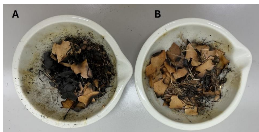
Fig. 27 e 28 – Resultados do 1.º ensaio (A. Pulverização apenas com água; B. Pulverização com solução de água e precipitado contendo estruvite).
