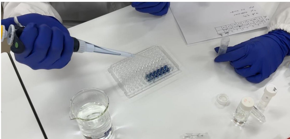
Fig.13 – Preparativos para a obtenção da curva de calibração pelo método colorimétrico.
