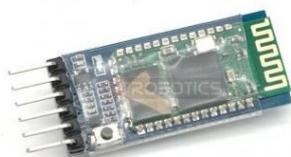
Com o Módulo *Bluetooth* HC-05 é possível a conexão entre um microcontrolador e um telemóvel. Usada para estabelecer o controlo remoto.
