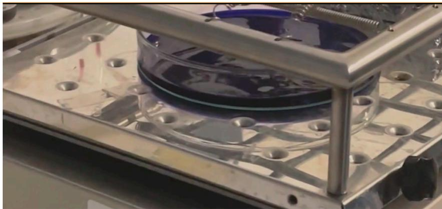
**Figura 2.** Agitação de 1h do gel após 1h30 das amostras em eletroforese em conjunto com o corante Azul de Coomassie para se observar os resultados da eletroforese.
