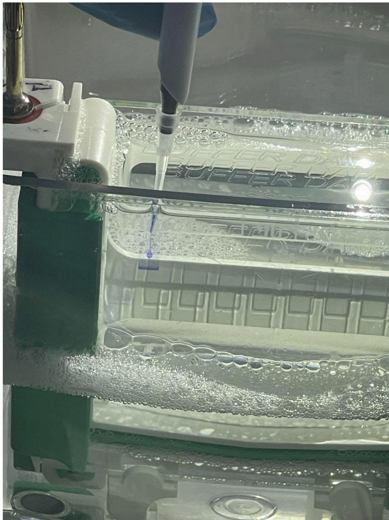
**Figura 1.** Pipetagem das amostras para o poço do gel, para a eletroforese. Neste caso, estava a ser pipetado o marcador de densidade.
