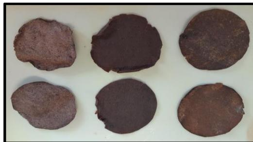
**Figura 11.** Biofiltros produzidos à base de pasta celulósica do talo de bananeira nanomodificados por imersão.
