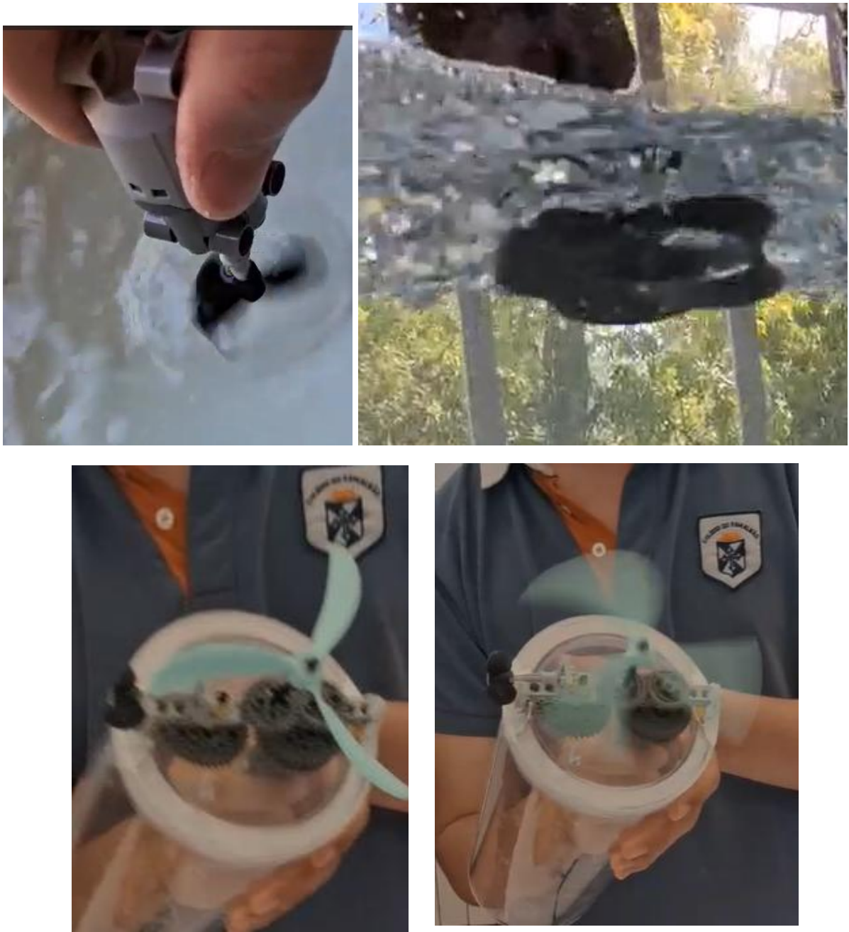
Figura 4 - Teste 3: verificação das hélices, foi necessário trocar a hélice de propulsão dianteira por uma mais leve.
