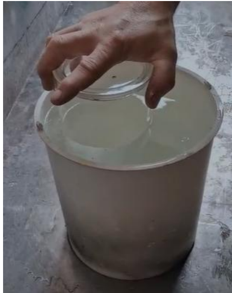
Figura 1 - Teste 1: verificação da estanquidade.
