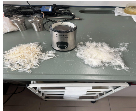
Fig.5- Processo de Trituração através de moinho
