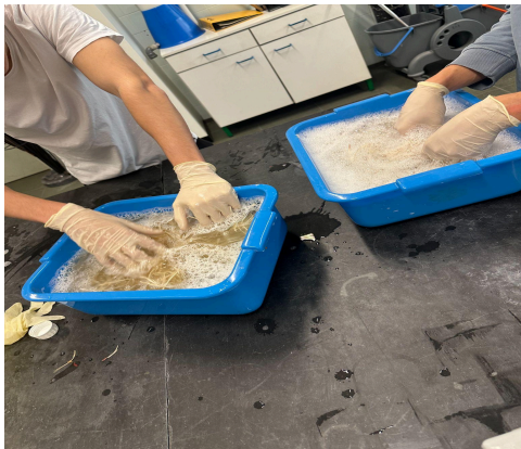
Fig.2- Lavagem tensoativa exaustiva
