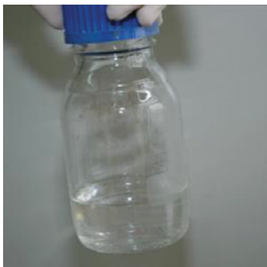
Figura 2 Solução de agarose (0,8%) fundida no micro-ondas
