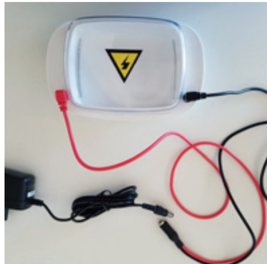
Figura 10 Ligação dos cabos e carregador à tina de eletroforese
