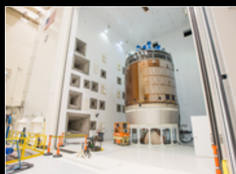
Teste acústico ao Módulo Europeu de Serviço, Modelo Estrutural
