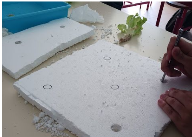
Legenda: Corte de pequenos círculos na placa de esferovite, para inserir as alfaces. Data: 12 / 04 / 24
