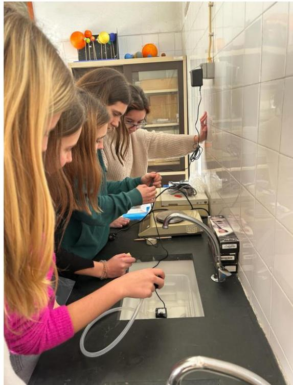
*Legenda: montagem e perceção do funcionamento da bomba de água*
