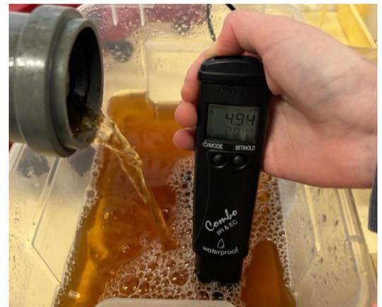
Legenda: Condutímetro utilizado
