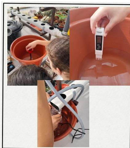
*Legenda: Determinação do pH, Condutividade, Temperatura e cálculo do fluxo da água*
