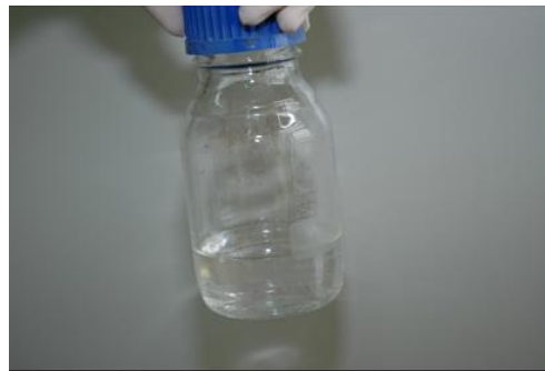
Figura 8: Solução de Agarose (1%) fundida no microondas
