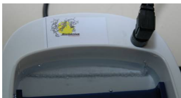
Figura 17: Electroforese a decorrer. Visualização de bolhas de gás a libertarem-se do eléctrodo.
