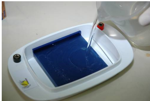
Figura 12: Verter o tampão cuidadosamente para a tina
