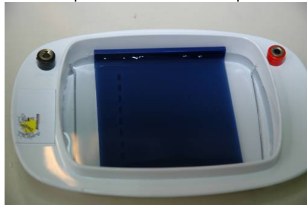
Figura 13: Gel totalmente coberto com tampão TBE-
