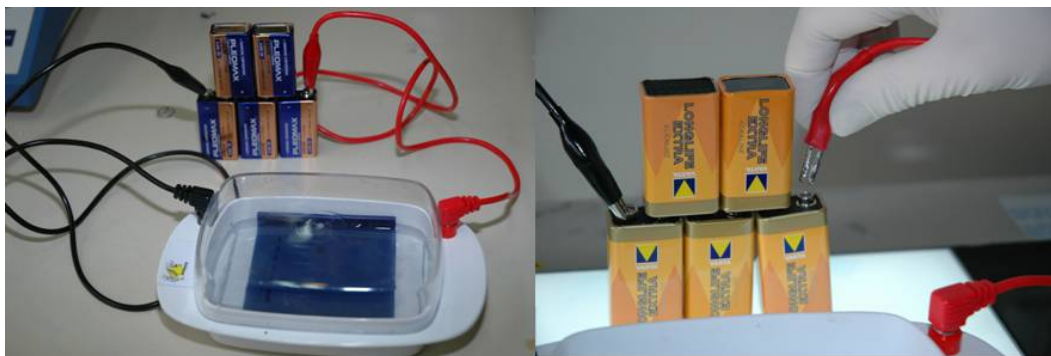
Figura 16: Sistema de electroforese montado. Electroforese a decorrer
