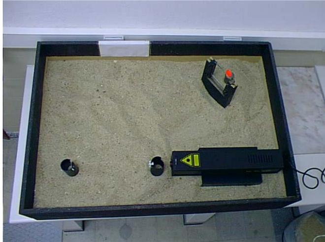
Fig. 10: Fotografia da montagem experimental para holografia de reflexão no sistema caixa de areia.
