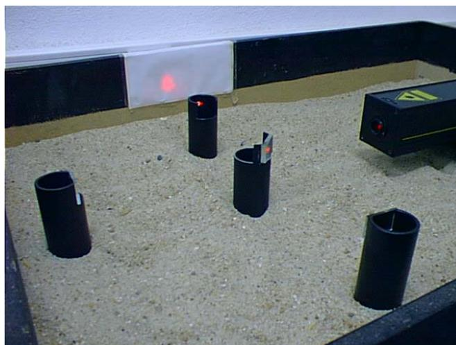
Fig. 9: Fotografia da montagem do interferômetro de Michelson no sistema caixa de areia.
