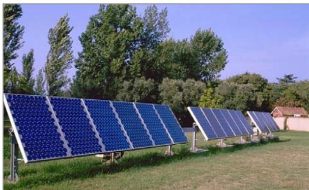
Plataforma fotovoltaica de testes de sistemas de 2,2 kWp (1989)
