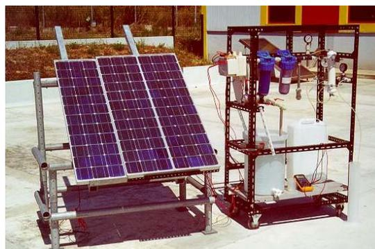
Sistema de electrificação autónomo de produção de água por osmose inversa -
