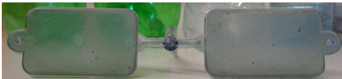
Figura 4.7 - PET com 1 hora a 85 °C na estufa e 6 horas a 170 °C no desumidificador
