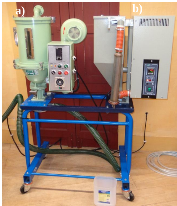
Figura I.1 a) Secador CONAIR; b) Desumidificador CONAIR.
