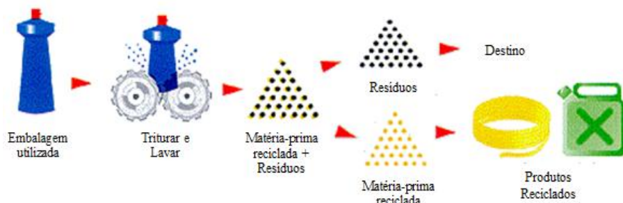
Figura 2.5 - Fluxograma das etapas da reciclagem mecânica Adaptado: PLASTIVIDA, 2009
