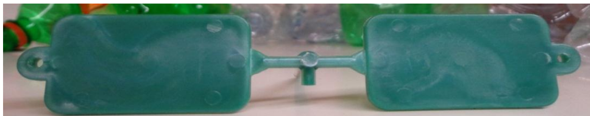
Figura 4.12 - PET e PE com 1 hora a 85 na estufa e PET com mais 2 horas a 140 C no desumidificador
