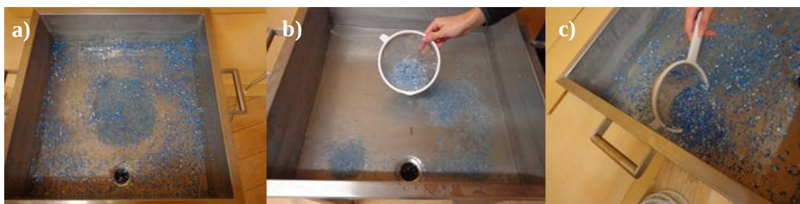
Figura 4.4 - Teste de separação por densidades; a) Separação do PE do PET; b) Remoção do PET; c) Remoção do PE.
