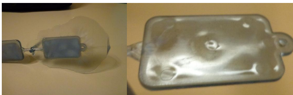
Figura 4.14 - Defeitos resultantes da inadequação das variáveis operatórias de injeção; a) Rebarba; b) Rechupe.
