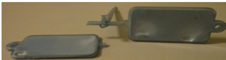
Figura 4.10 - PET com 1 hora a 85 °C na estufa
