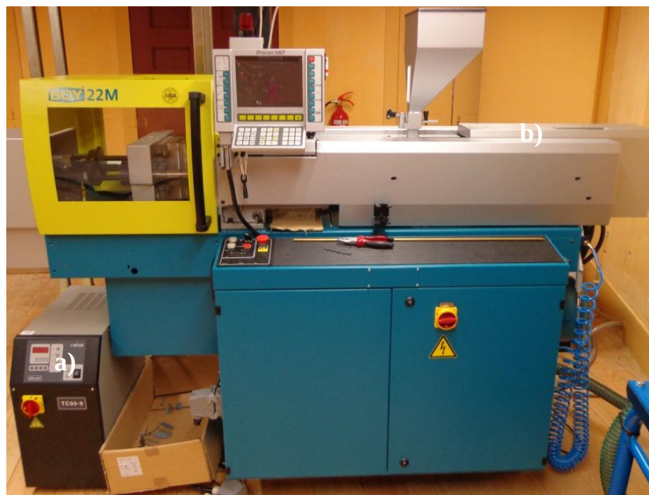
Figura I.8 a) Termorregulador; b) Injetora BOY 22M.
