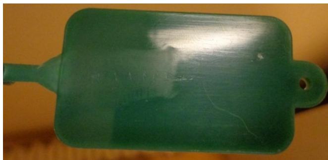
Figura 4.13 - PET com 1 hora a 85 °C na estufa e 6 horas a 170 °C no desumidificador
